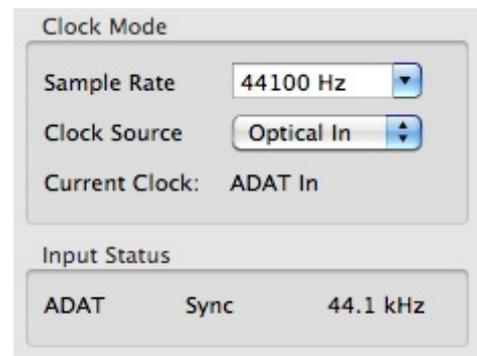
Das erstmalig in der RME Hammerfall eingesetzte Verfahren **SyncCheck** dient der einfachen Prüfung und Anzeige der aktuellen Clock-Situation. Die mit Input Status beschriftete Statusbox zeigt für die Eingänge ADAT, SPDIF und Word Clock getrennt an, ob kein Signal (No Lock), ein gültiges Signal (Lock), oder ob ein gültiges *und* synchrones Signal anliegt (Sync). Im Feld *Clock Mode* wird angezeigt zu welchem Signal die Synchronität besteht (siehe auch Kapitel 39.1).
