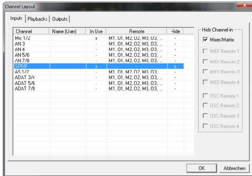
Die Reihen Inputs, Playbacks und Outputs haben jeweils eine eigene Seite, mit Zugriff über die Reiter oben. *In Use* zeigt die derzeit im Mix verwendeten Kanäle.
