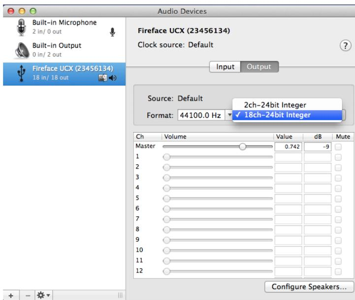
Mac OS X unterstützt USB Audio 2.0, sogar mit mehr als 2 Kanälen. Das UCX bietet volle 18 Eingangs- und 18 Ausgangskanäle bei bis zu 96 kHz. Es wird als "Fireface UCX (xxxxxx)" im Audio MIDI Setup gezeigt, sowohl im normalen als auch im CC-Modus. Im CC Modus verschwindet der USB Settingsdialog, und TotalMix zeigt – wenn überhaupt – ein 'disconnected' UCX.
