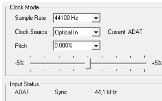
Damit wird eine Konfiguration der jeweiligen Software zur Durchführung einer digitalen Aufnahme zum Kinderspiel. Nach der Wahl des richtigen Eingangs das Fireface die aktuelle Samplefrequenz. Diese ist dann im Eigenschaftendialog des jeweiligen Aufnahme-Programms bzw. direkt im Settingsdialog einzustellen.
