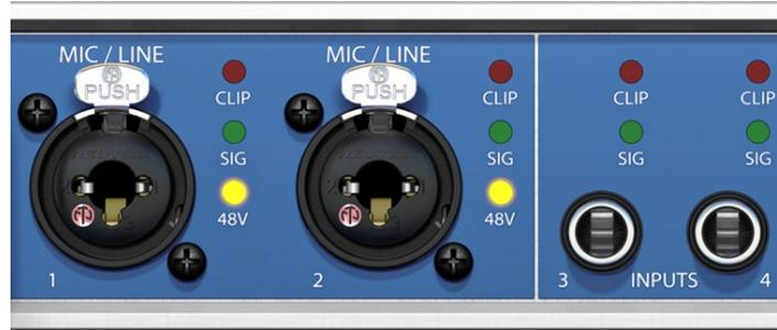
Über Eingang 3/4, **INST/LINE**, lässt sich per 6,3 mm Klinkenstecker sowohl ein symmetrisches Line-Signal als auch ein unsymmetrisches Instrumentensignal einspeisen.
