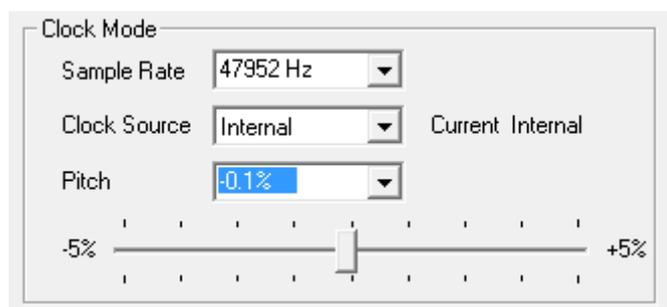
Pitch erlaubt die Änderung der Samplefrequenz aller WDM-Devices gleichzeitig. Dies ist seit Vista nicht mehr von der Applikation aus möglich, erfordert normalerweise eine manuelle Umkonfiguration aller WDM-Devices. Die Änderung der Sample Rate im Settingsdialog löst dieses Problem. Da die Änderung im System einige Zeit dauern kann, sollte man eine Aufnahme / Wiedergabe nicht sofort nach der Änderung starten, sondern erst nach circa 5 Sekunden.
