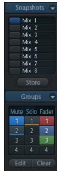
TotalMix führt mittels Blinksignalen durch die Benutzung der Gruppenfunktion. Nach dem Klick auf Edit und Klick auf den gewünschten Speicherplatz werden alle für diese Gruppe gewünschten Funktionen aktiviert bzw. selektiert. Der Speichervorgang wird mit einem weiteren Klick auf Edit beendet.
